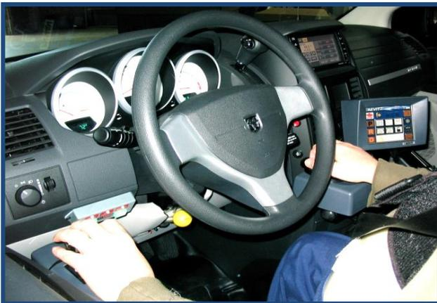
Palanca electrónica de acelerador y freno para el brazo izquierdo y volante electrónico para el brazo derecho.
